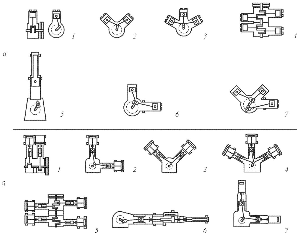
**Типовые конструкции поршневых компрессоров и двигателей-компрессоров:**
