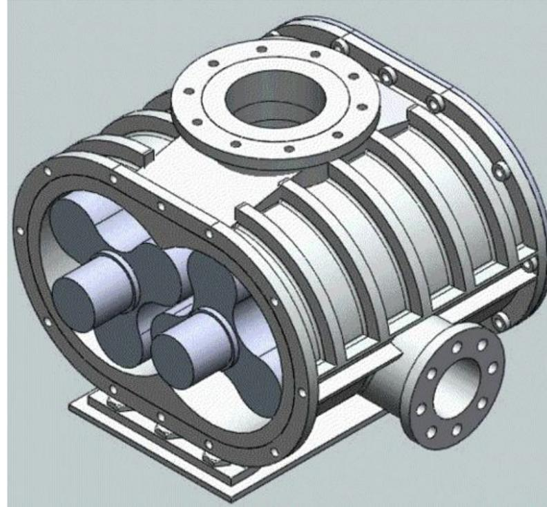
**Двухроторная ротационная газодувка:**
