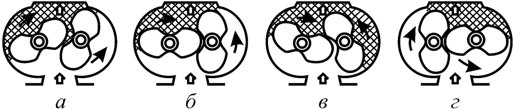
**Принцип работы двухроторного компрессора типа Рутс:**
