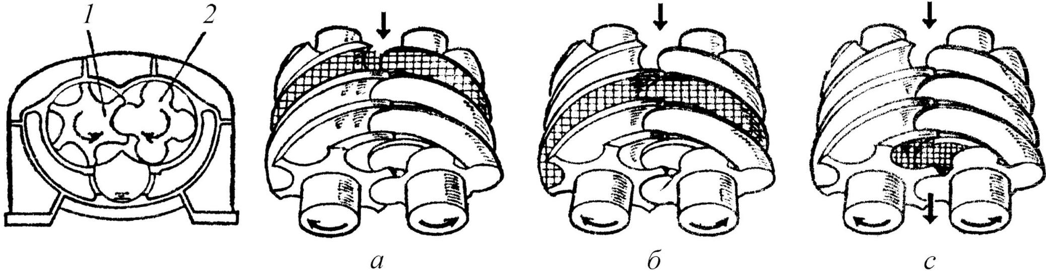
**Процесс работы винтового компрессора**
