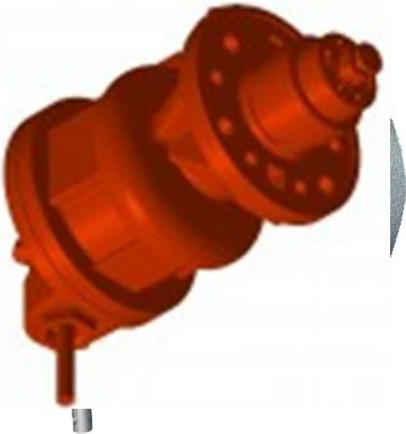
Главная часть воздухораспределителя 483
