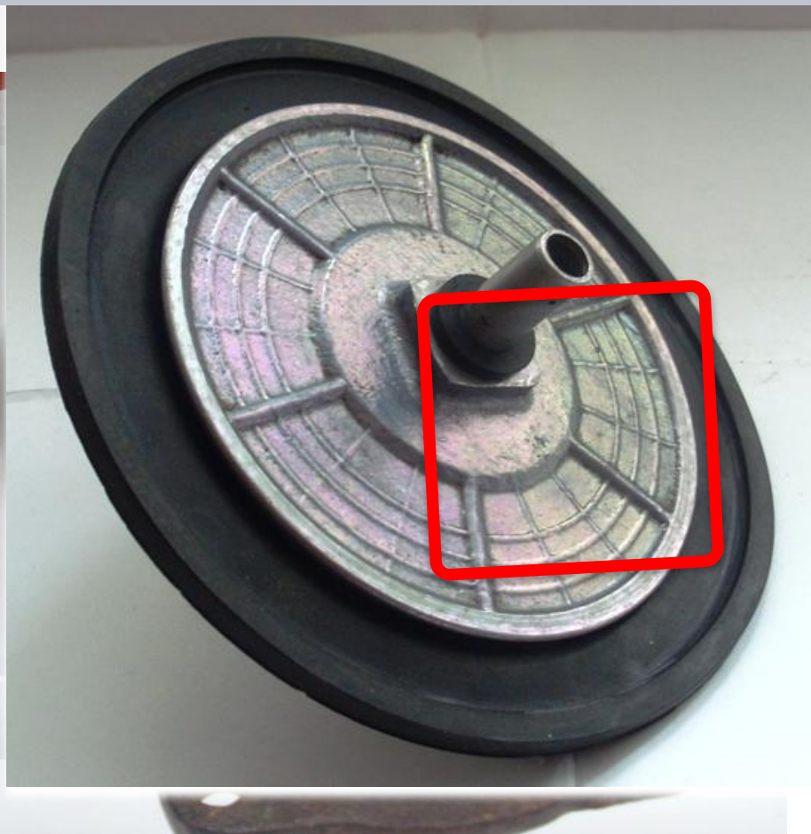
Магистральная часть воздухораспределителя 483
