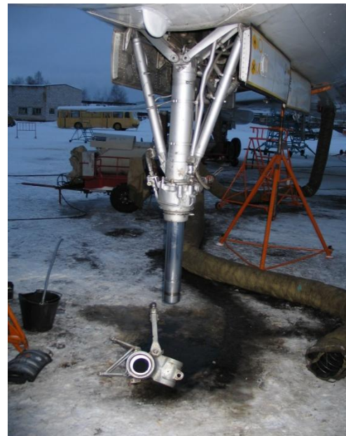
Рис. Рабочее место, для проверки деталей шасси неразрушающими методами контроля, развернутое непосредственно на месте стоянки самолета
