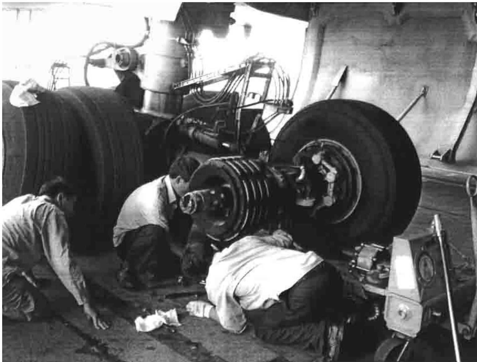
Рис. Рабочее место по мелкому ремонту тормозов основной стойки шасси
