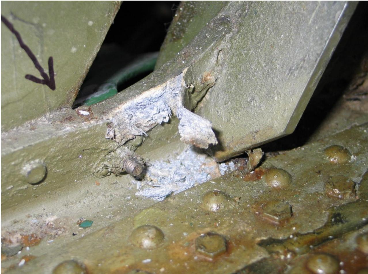
**Рис. Расслаивающаяся коррозия**
