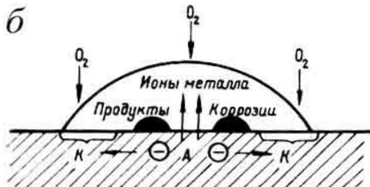
Рис. Схема электрохимической коррозии:
