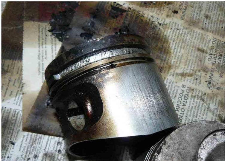
Причиной подклинивания чаще всего является образование **лаковых отложений** на поверхности поршня и цилиндра, а также обычная грязь или неравномерный износ поршня, вызывающий его перекос.
