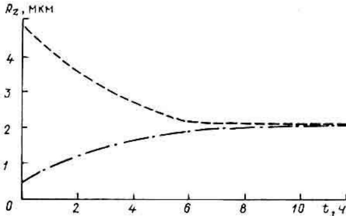
Рис. Образование «равновесной» шероховатости на деталях сопряжения на стали 45 и бронзы БрСНС-5-5-5 в процессе приработки:
