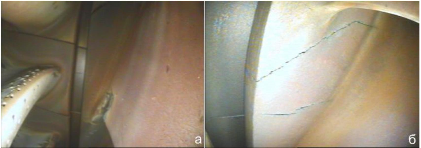
Рис. Повреждения лопаток соплового аппарата ТВД двигателя CFM56-5В:
