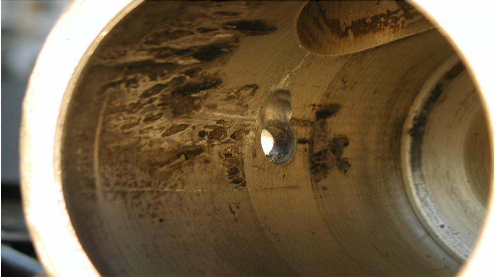
**Рис. Задирь (питтинг) внутри головки
