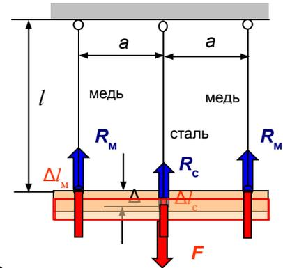
Подстановка соотношений упругости в уравнения совместности приводит к ранее полученному выражению для  $R_M = R_M(R_c)$ . Подстановка в уравнение равновесия дает:
