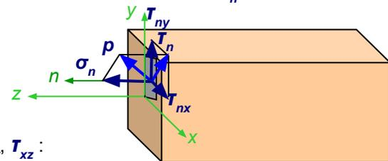
Касательное напряжение, в свою очередь, может быть разложено на две составляющие, параллельные координатным осям  $x, y$ , связанным с поперечным сечением –  $T_{nx}, T_{ny}$ :
