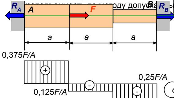
Условие прочности по допускаемым напряжениям:
