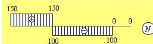
И пусть **прямолинейный брус** нагружен **продольными силами**. Построим эпюру продольных сил:
