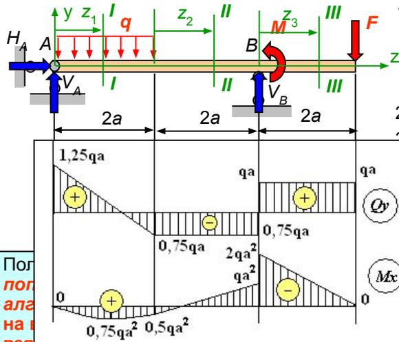
1. Определяем опорные реакции:
