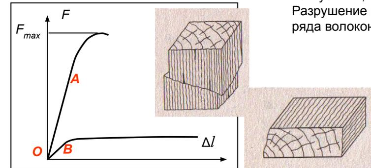
При сжатии *поперек волокон* на участке *ОВ* древесина работает почти упруго, деформации растут пропорционально увеличению сжимающей силы. Далее деформации начинают расти очень быстро при малом увеличении силы, вследствие уплотнения (спрессовывания) отдельных волокон. При наличии сучков и других пороков (трещин) образец может разрушиться раскалыванием. Разрушающая нагрузка определяется условно при достижении деформации сжатия, при которой высота образца уменьшается на треть исходной высоты .
