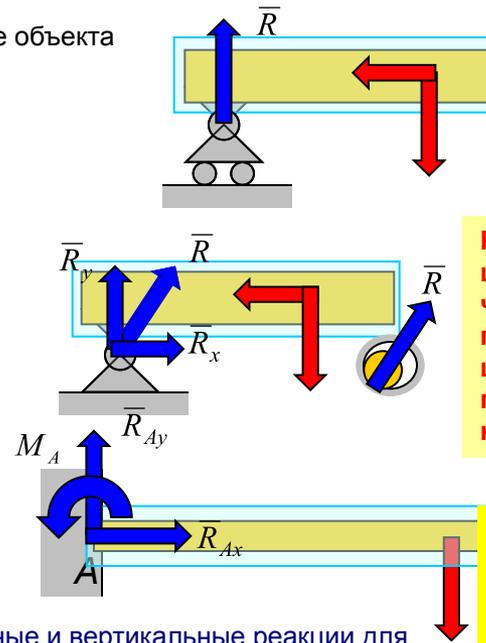
Реакция подвижного шарнира проходит через центр шарнира перпендикулярно оси шарнира и плоскости опирания.
