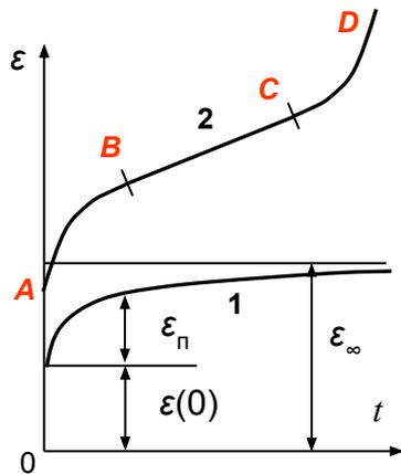
Результаты испытаний на ползучесть представляют графиками изменения деформаций во времени (*кривые ползучести*). В начальный момент времени деформации имеют ненулевое значение  $\varepsilon(0)$ , равное упругой деформации или сумме упругой и пластической деформаций. Считается, что время предварительной нагрузки (или разгрузки) пренебрежимо мало по сравнению со временем выдерживания нагрузки, поэтому можно принять, что деформации  $\varepsilon(0)$  и напряжение появляются как бы мгновенно.
