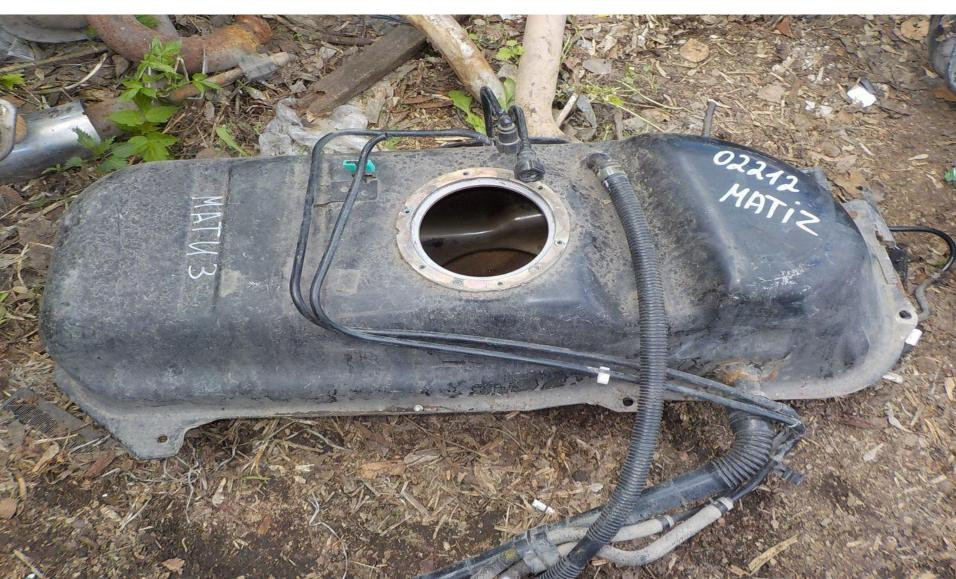
Бак заполняют топливом через горловину, которая закрывается пробкой. В пробке топливного бака имеются паровой и воздушный клапаны. Паровой клапан предохраняет бак от разрыва, в случае повышения давления паров бензина. Воздушный клапан предохраняет от возможности прекращения подачи топлива к карбюратору из-за создавшегося в баке разрежения
