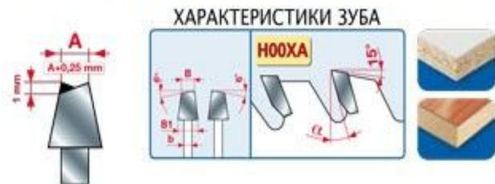
▲ При каждом регулировании высоты на 1 мм подрез становится на 0,25 мм шире
