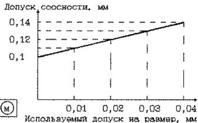
Рис. 3.23. Допуск отклонения от соосности, зависящий от действительного размера (а) и значения допуска при разных значениях действительного размера (б)
