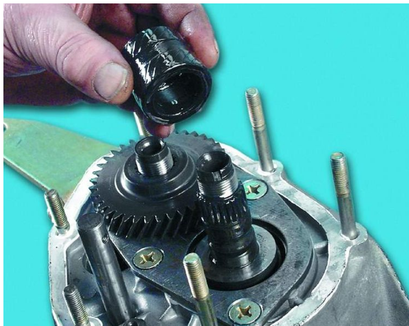
12. Снимите втулку с вторичного вала.
