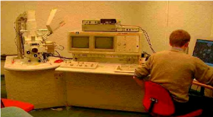
Электронный микроскоп Jeol JSM 6200
