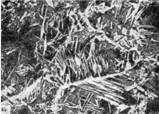
Структура доэвтектоидной стали. Перлит и феррит в виде сетки и игл, \times 100
