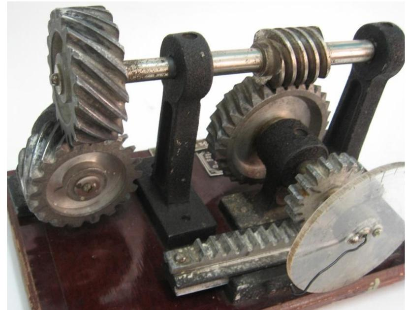
Зубчатая передача состоит из двух колес или колеса и рейки с зубьями, посредством которых они сцепляются между собой
