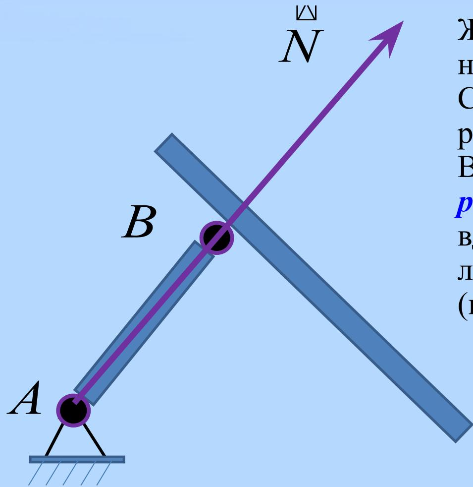
Жесткий невесомый **стержень** на концах которого шарниры. Стержень при этом может растягиваться или сжиматься. В зависимости от этого **сила реакции стержня** направлена вдоль него от точки крепления либо к точке крепления (вспомним **Аксиому 1**)
