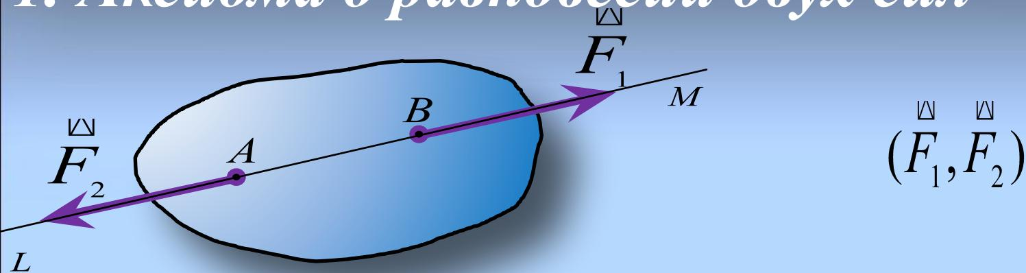
Абсолютно твердое тело находится в равновесии под действием **двух сил** только когда эти силы равны по модулю, противоположно направлены и линии их действия совпадают.
