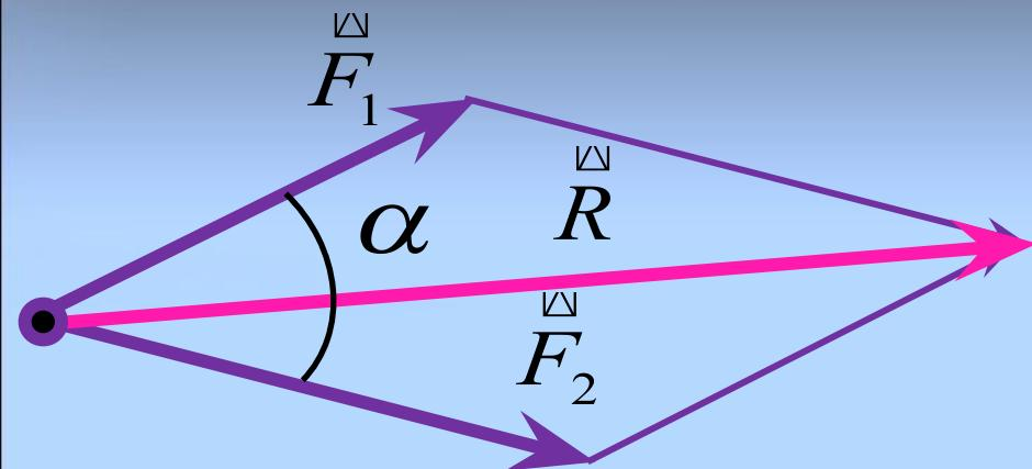
**Две силы** приложенные к телу в одной точке, можно заменить **одной равнодействующей силой**, равной по модулю и направленной по диагонали параллелограмма, построенного на заданных силах.
