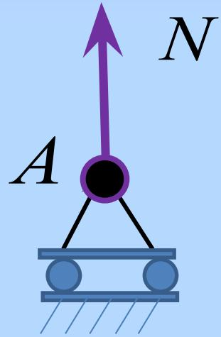
Данный тип **связи** препятствует движению в направлении поверхности опирания, но не препятствует перемещению вдоль этой поверхности. Следовательно, **сила реакции** направлена перпендикулярно (**по нормали**) к поверхности опирания.
