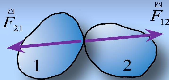
**Силы** взаимодействия **двух тел** равны по модулю и направлены вдоль одной прямой в противоположные стороны.
