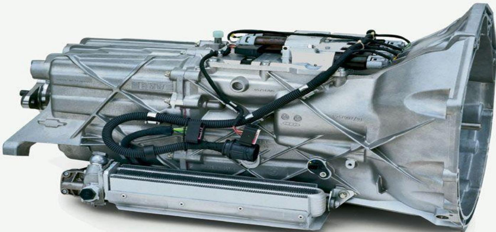
Гидравлический привод осуществляется с помощью гидроцилиндров, которые управляются электромагнитными клапанами
