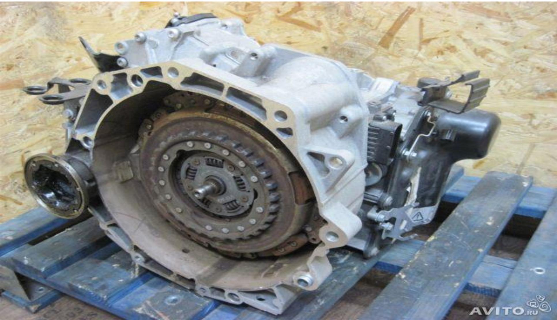
Решение указанной проблемы было найдено в применении коробки передач с двумя сцеплениями, обеспечившей переключение передач без разрыва потока мощности
