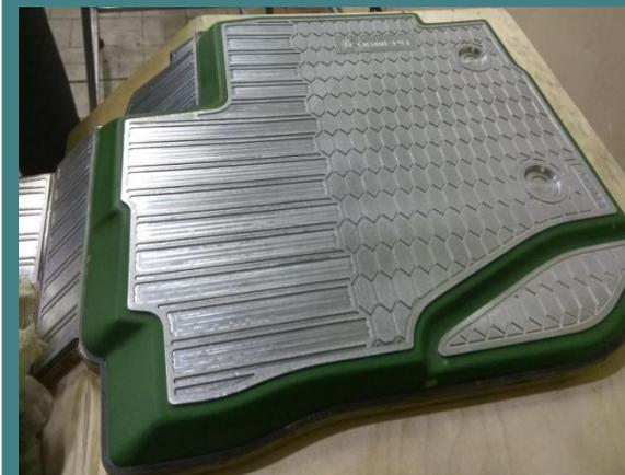
3. К форме подведена вакуумная трубка. Сама форма имеет множество отверстий. На форму сверху кладется расплавленная масса ТЭП, воздух откачивается, придавая необходимые рисунок.
