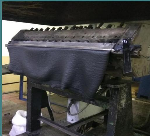
2. В экструдере гранулы расплавляются и под давлением на выходе образуют однородную пластичную массу, от которой отрезается кусок и помещается на металлическую форму.
