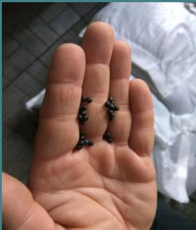
1. Гранулы ТЭП засыпаются в специальный аппарат – экструдер.
