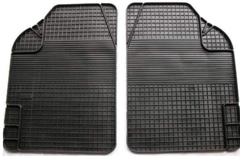
**Резиновые коврики** имеют относительно невысокую цену и доступны каждому автомобилисту. Качество сильно зависит от использованного материала, т.к. в производстве можно использовать даже вторсырье. Например, старые автомобильные покрышки.
