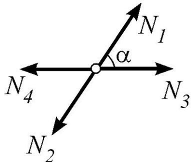
**4.** Если в четырехстержневом узле стержни попарно лежат на одной прямой, а внешней нагрузки нет, то усилия также попарно равны между собой:
