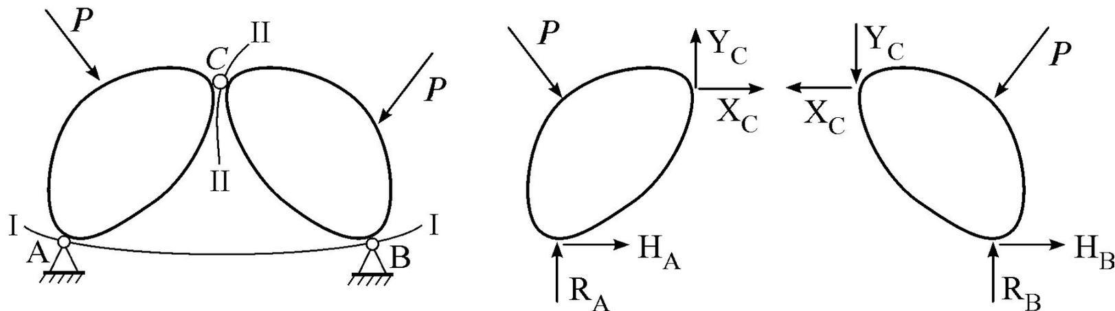
В результате появляются независимые две части с шестью неизвестными (четыре опорные реакции  $R_A$ ,  $R_B$ ,  $H_A$ ,  $H_B$  и две междисковые реакции  $X_C$ ,  $Y_C$ ).
