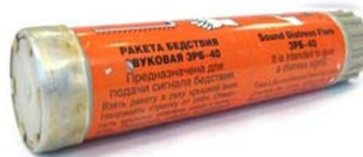
Для пуска ракеты отворачивается колпачок с хвостовой части ракеты, вынимают шнур с кольцом, пропускают его по пазу в боковой части стакана в донное отверстие и выдергивают шнур сильным рывком. Ракета взрывается на высоте, имитируя пушечный выстрел, слышимый на расстоянии до 5 миль.
