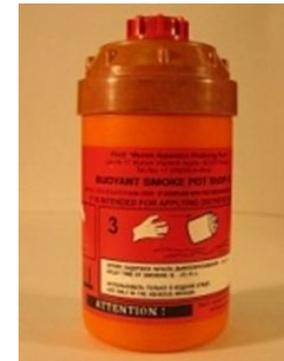
Перед тем как бросить шашку в воду, отвинчивают головку с ее корпуса, соединяют концы шплинта и выдергивают их наружу. Через 2 – 3 с после того, как из центрального отверстия в корпусе покажется дым, шашку бросают в воду. Примерно через 30 с начинается образование густого оранжевого дыма, который выделяется в течение не менее 3 мин, если шашка находится на тихой воде. Дым продолжает выделяться при погружении шашки в воду в течении 10 с на глубине до 10 см.
