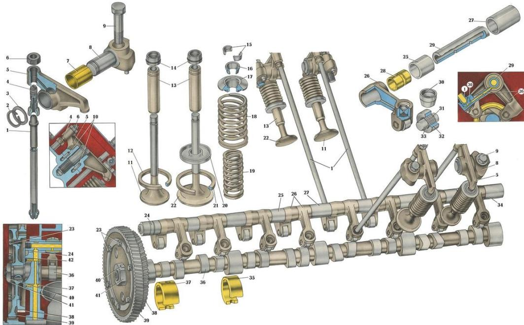
**Два слова о ГРМ** . Клапанный механизм газораспределения, сокращенно ГРМ, — это то, без чего четырехтактный двигатель существовать в принципе не может. Он открывает впускные клапана, впуская воздух или горючую смесь в цилиндры на такте впуска, открывает выпускные на такте выпуска и надежно запирает горящую в цилиндре смесь во время рабочего хода
