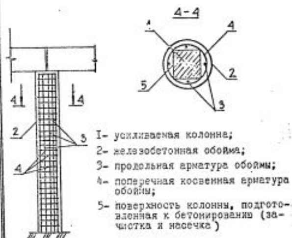
УСТРОЙСТВО ЖЕЛЕЗОБЕТОННОЙ ОБОЙМЫ С КОСВЕННЫМ АРМИРОВАНИЕМ
