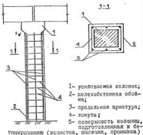
УСТРОЙСТВО ЖЕЛЕЗОБЕТОННОЙ ОБОЙМЫ С КОСВЕННЫМ АРМИРОВАНИЕМ
