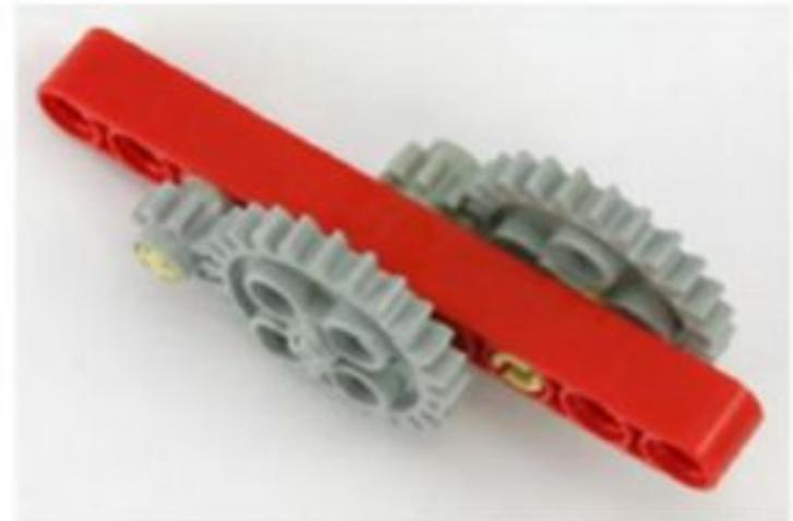
$$i = i_{12} \cdot i_{34} \cdot i_{56} \dots, \text{ где } i_{12} = \frac{z_2}{z_1}, i_{34} = \frac{z_4}{z_3}, i_{56} = \frac{z_6}{z_5} \dots$$
