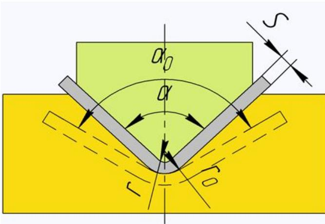
Величина упругого пружинения различна для свободной гибки без калибровки материала и для гибки в упор с калибровкой материала и чеканкой угла.
