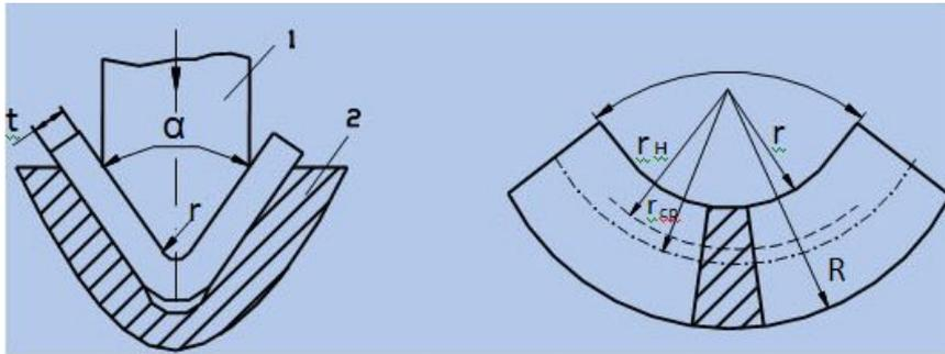
Рисунок 1.1 Схема процесса гибки
