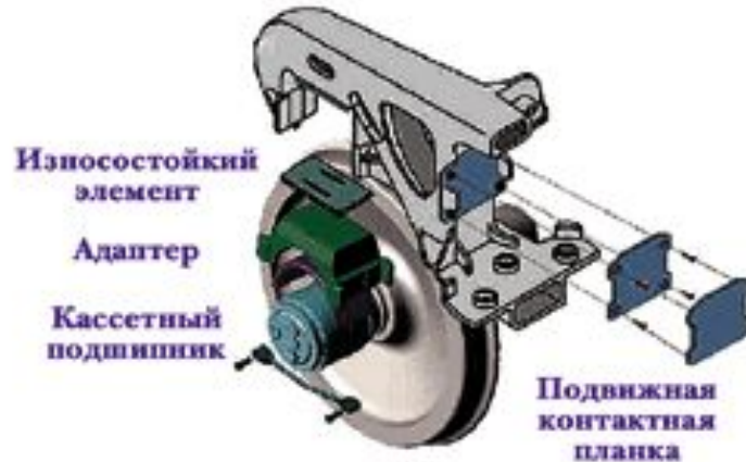
Модифицированный клин с износостойкой пластиной
