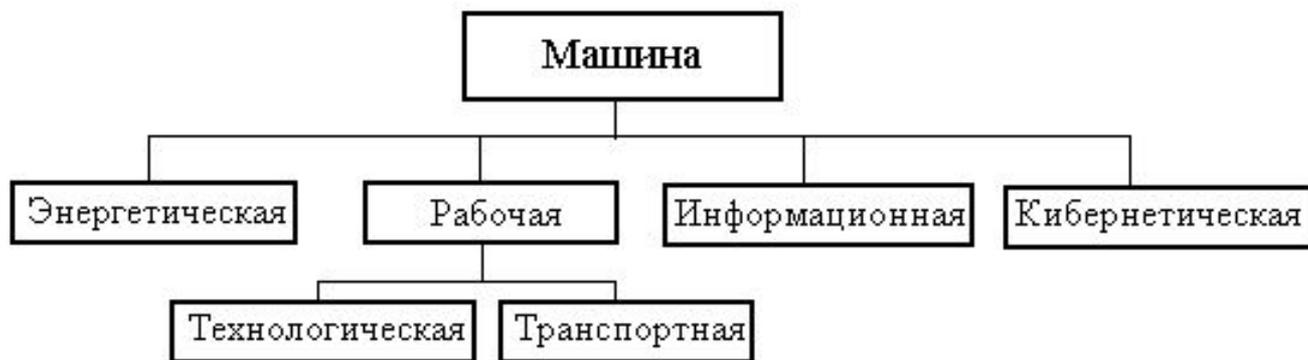
Рисунок 1- Классификация машин
