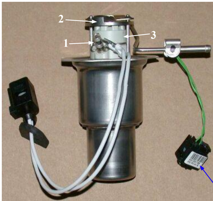
1 – штифт накала 2 – топливная система
