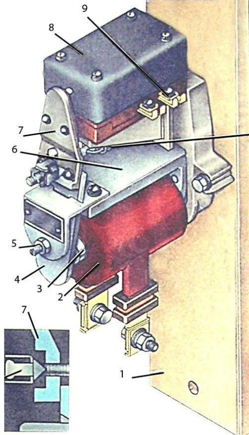
Реле перегрузки РТ-502
