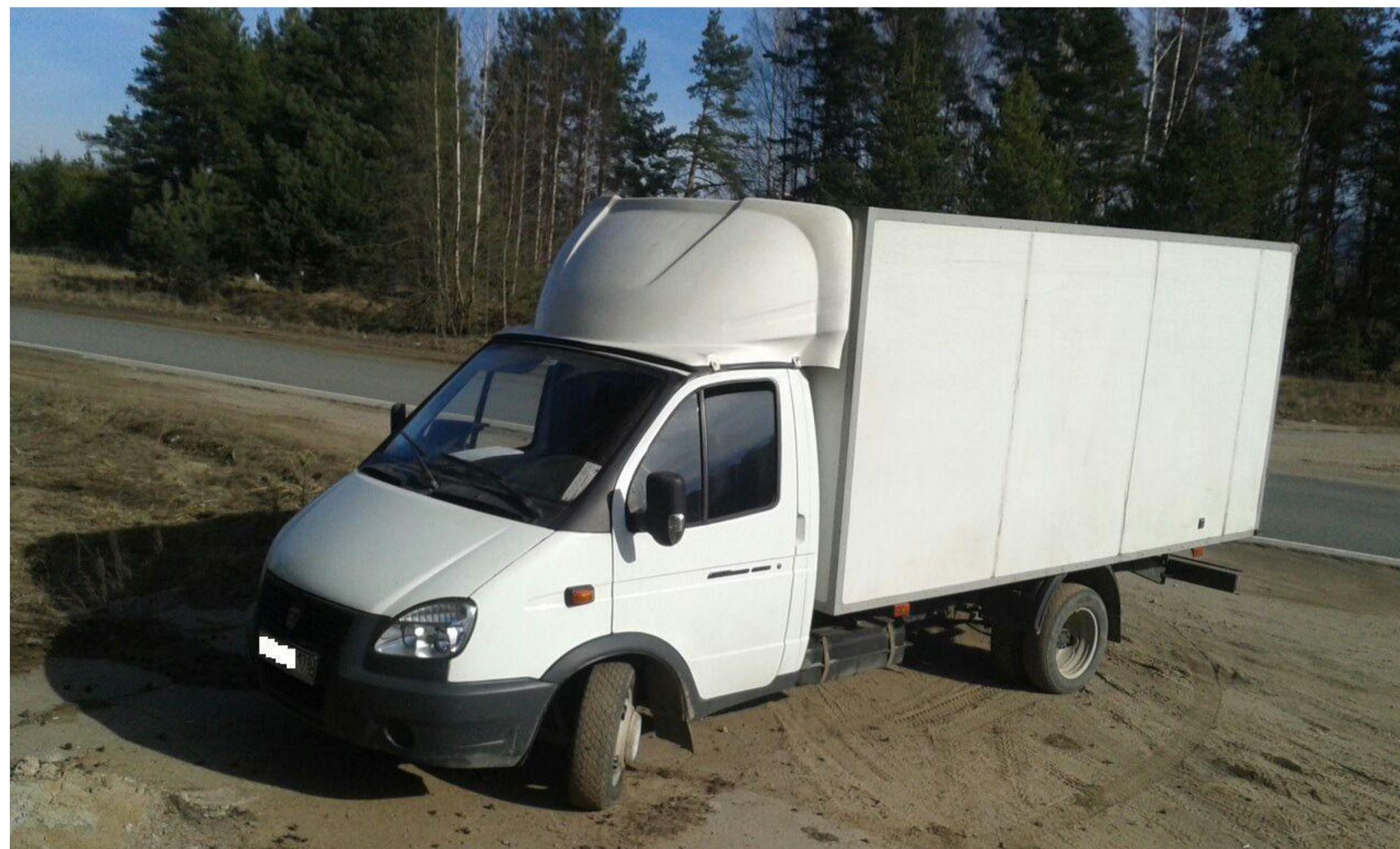
а) обтекатель-спойлер, б) ГАЗ-3302 «Газель» с обтекателем
