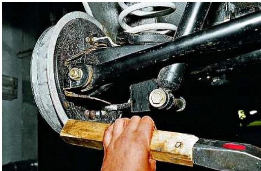
Снятие заднего барабана ВАЗ 2107
