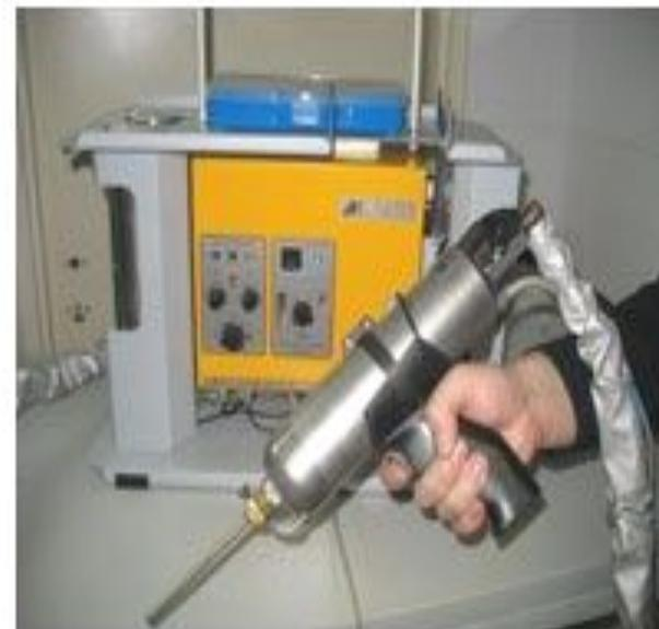
Технология газодинамического напыления металлов ДИМЕТ® включает в себя нагрев сжатого газа (воздуха), дальнейшее поступление его в сверхзвуковое сопло с формированием в сопле воздушного потока сверхзвуковой скорости.
