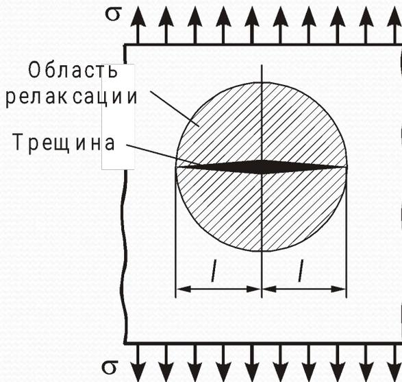
Главная идея теории Гриффитса состоит в том, что **потенциальная энергия** тела, накопленная им в процессе упругого деформирования, при разрушении полностью превращается в **энергию образующихся новых поверхностей (поверхностную энергию)**.
