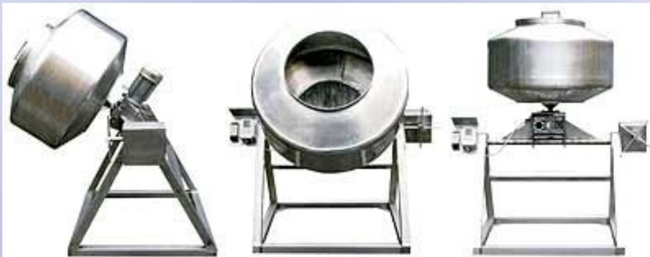
Форма котла, степень его загрузки, скорость вращения, наклон котла к горизонтали, а также площадь поверхности дражированных таблеток значительно влияют на качество покрытия.
