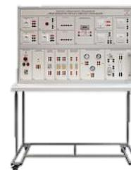
Лабораторный стенд «Рабочее место электромонтажника»
