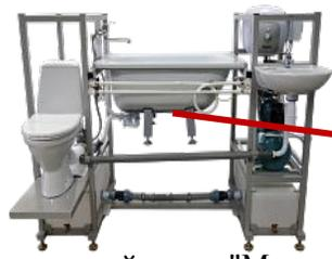
Лабораторный стенд "Монтаж сантехнического оборудования"
