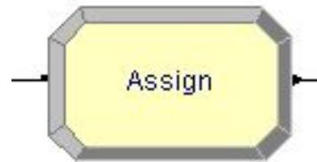
Этот модуль предназначен для задания нового значения переменной, атрибуту сущности типу сущности, анимационной картинке сущности или другой переменной в системе.
