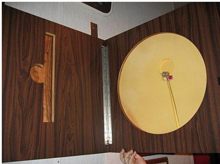
. Размещенный внутри объекта, «Златоуст» приводился в действие микроволновым излучением из удаленного источника. Под влиянием человеческого голоса в помещении меняется характер колебаний, которые и фиксировал эндовибратор. Устройство записывало колебания на пленку, после чего их восстанавливали специальным образом и записи превращались в первоначальную речь.
