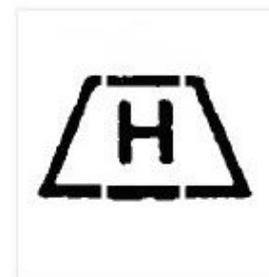
Ружье испытано усиленным зарядом нитропороха
