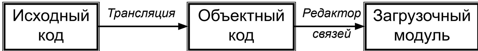
Рис. Процесс создания программы,
