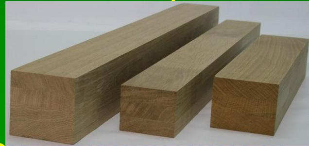
Бревна отбираются с низкой сучковатостью примерно одинаковой толщины, ровные, не деформированные диаметром 27-40 см. Для производства клееного бруса пиломатериал подвергают мягкой камерной сушке.
