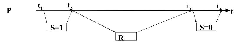
$t_1 - t_2 - вспомогательный критический интервал (блокирование обработки прерываний и занятие переменной состояния) <math>t_2 - t_3 - основной критический интервал (прерывания разрешены) <math>t_3 - t_4 - вспомогательный критический интервал (блокирование обработки прерываний и освобождение переменной состояния)$
