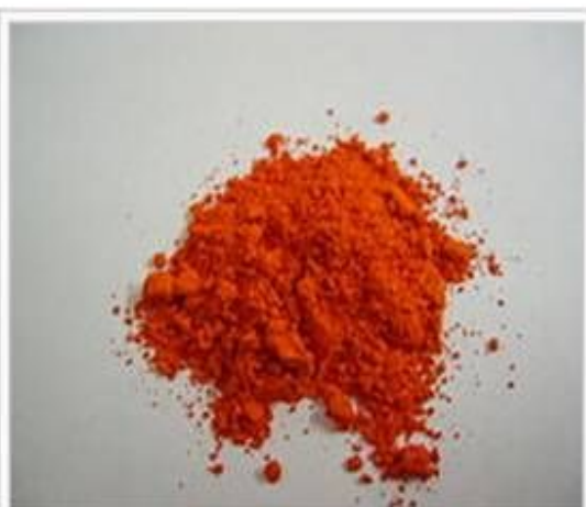
Свинцовый сурик (оксид свинца Pb_3O_4 )
