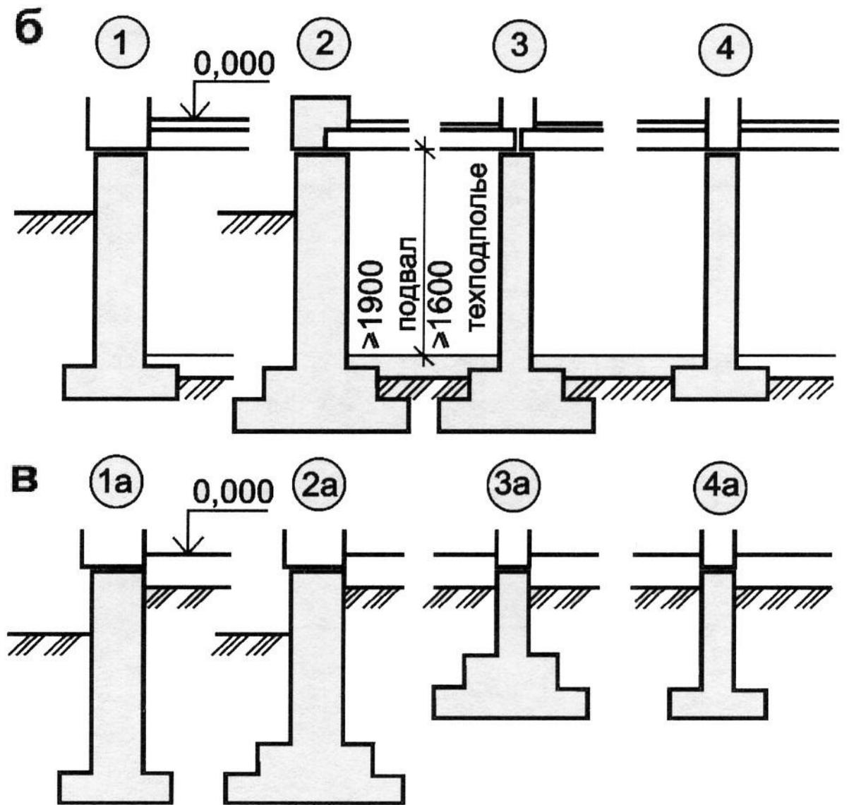
Рис. 9.1. Монолитные ленточные фундаменты:
