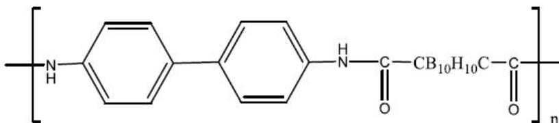
*Рисунок 3. Структура карборансодержащего полиамида*
