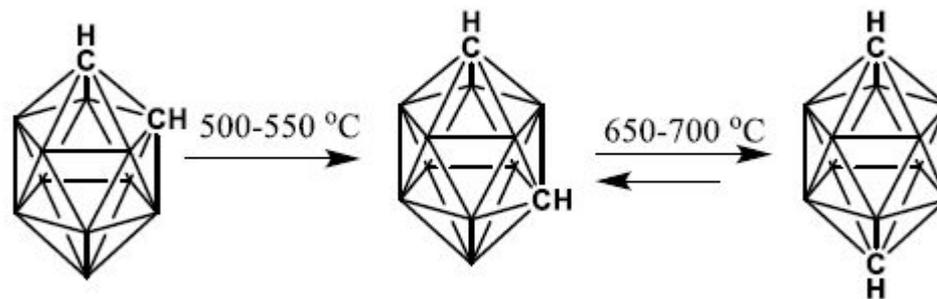
*Рисунок 2. Термические перегруппировки карборанов*
