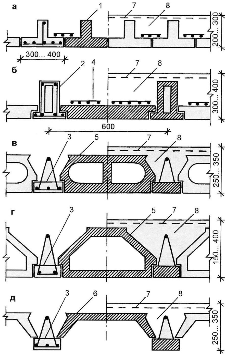
Рис. 7.2. Балочные сборно-монолитные перекрытия:
