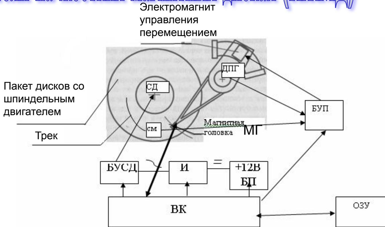
БУСД - блок управления 3-х фазным синхронным двигателем шпинделя;
