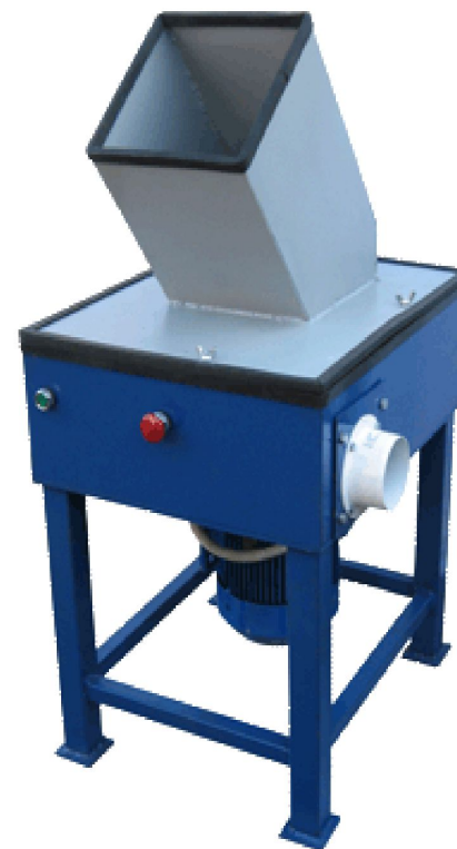
Дробилка ВС 40 для измельчения вспененных полимеров: поролон, пенопласт, «Изолон», мощность до 2 м 3 /час, производство Россия
