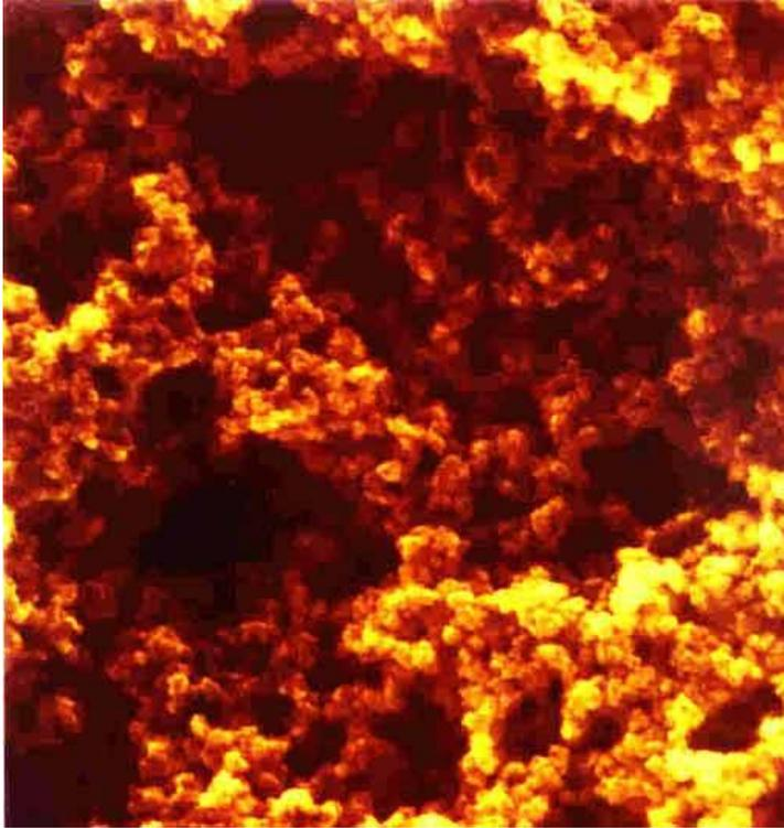
Наножелезо 10 – 20 нм из  $\text{Fe}(\text{CO})_5$
