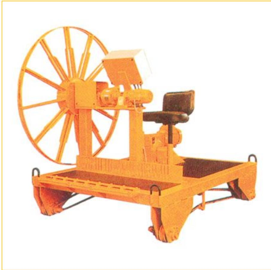
Машина предназначена для раскладывания арматуры (проволоки, канатов) по всей длине дорожки. Имеет две скорости перемещения, снабжена устройством намотки кабеля с фрикционным механизмом, позволяющим выполнять плавное наматывание кабеля.
