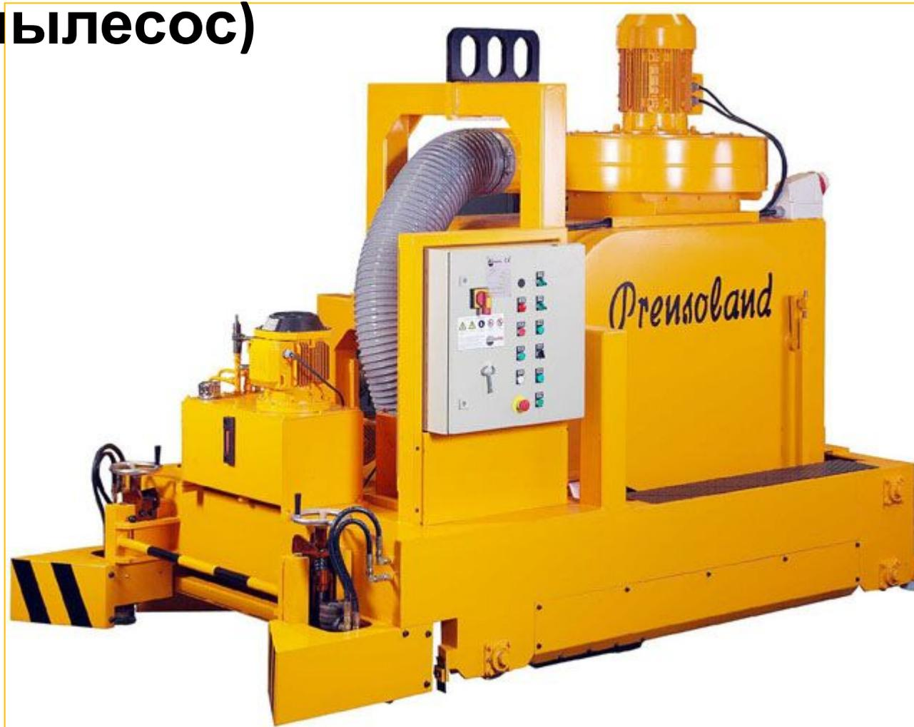
**Машина для уборки дорожки после формовки от остатков бетона, имеющая дополнительную функцию смазки дорожки перед раскладкой проволоки.**
