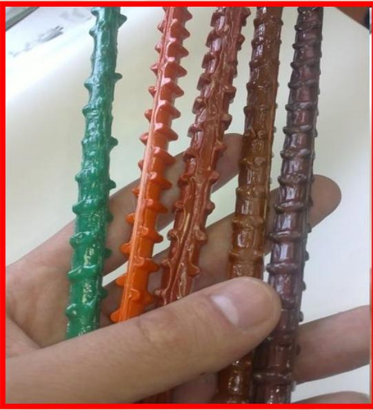
**До 2014 года каждый производитель композитной арматуры работал в соответствии с ТУ, разработанными на предприятии, по индивидуальной технологии. Результат... Разный профиль изделий, «пестрая» маркировка. Теперь все перешли на единую систему обозначений.**
