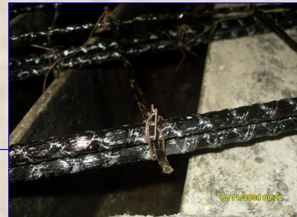
**Композитная арматура «ЛИАНА»** состоит из армирующих элементов и матрицы. В качестве армирующих элементов используются непрерывные высокопрочные стеклянные или базальтовые волокна объединенные в стержень полимерной матрицей на модифицированном эпоксидном связующем, методом безфильерной протяжки «плейнтрузии» с двойной спиральной обмоткой противоположных направлений (ноу-хау). **Арматура** имеет непрерывную ромбическую рельефную поверхность, которая обеспечивает **высокое сцепление с бетоном**.
