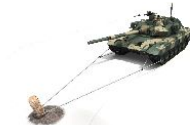
С помощью троса, прикрепленного к гусеницам застрявшей машины и к неподвижной опоре
