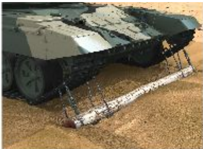
С помощью бревна, присоединяемого к гусеницам застрявшей машины
