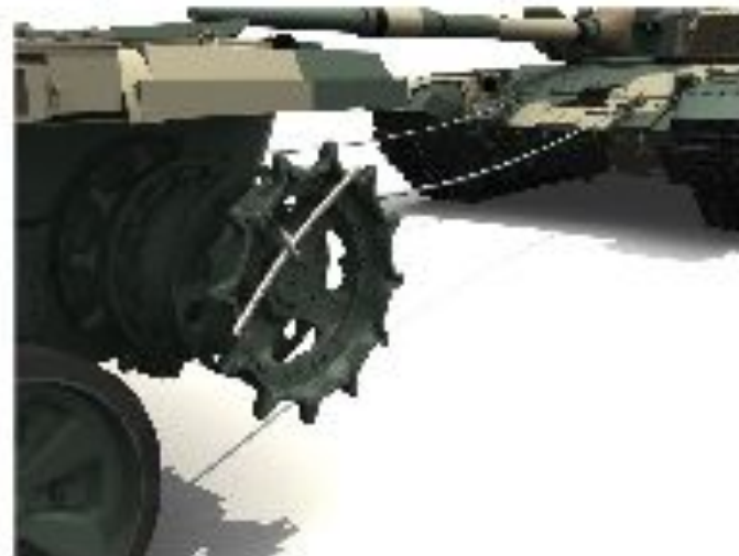
Использование ведущих колес застрявшей машины как барабанов лебедки
