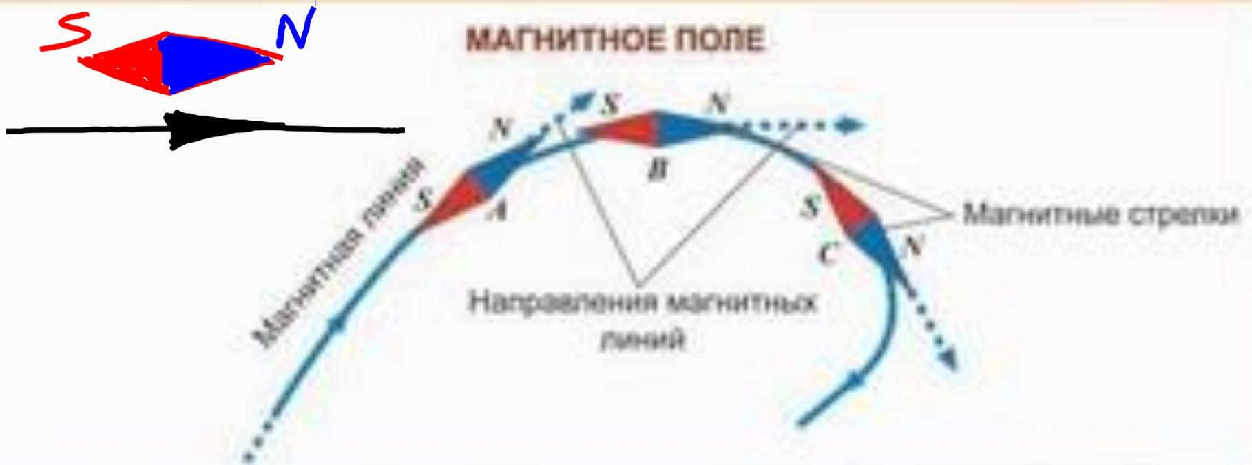
Выполненный опыт наводит на мысль о существовании вокруг проводника с электрическим током **магнитного поля**. Оно и действует на магнитную стрелку , отклоняя ее.
