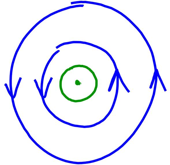
**ПРАВИЛО БУРАВЧИКА: ЕСЛИ НАПРАВЛЕНИЕ ПОСТУПАТЕЛЬНОГО ДВИЖЕНИЯ БУРАВЧИКА СОВПАДАЕТ С НАПРАВЛЕНИЕМ ТОКА В ПРОВОДНИКЕ, ТО НАПРАВЛЕНИЕ ВРАЩЕНИЯ РУЧКИ БУРАВЧИКА СОВПАДАЕТ С НАПРАВЛЕНИЕМ ЛИНИЙ МАГНИТНОГО ПОЛЯ ТОКА**
