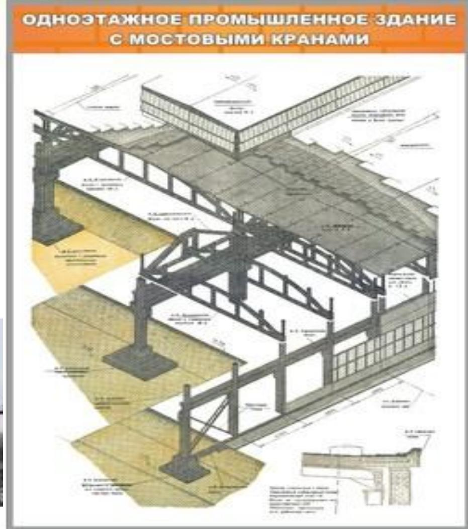
Все это вызывает в колоннах одноэтажных промышленных зданий значительные изгибающие моменты, и поэтому поперечные сечения таких колонн проектируют в виде вытянутого прямоугольника, двутавровыми, а при большой высоте —двухветвевыми. Колонны двутаврового сечения имеют несомненные преимущества в отношении экономии материала, снижения веса, но из-за большей сложности изготовления распространения не получили.
