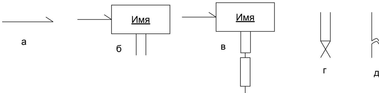
Условные обозначения асинхронных передач управления:
